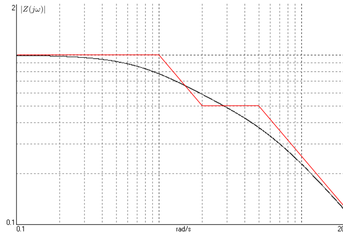
Figura 4.13: Módulo de uma impedância a realizar. Plotado também o digrama de Bode correspondente.
